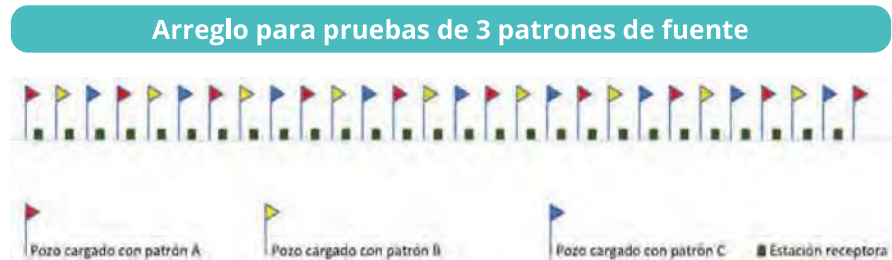
Figura 60. Ejemplo de un esquema para evaluar tres patrones de fuente diferentes con base en tres secciones sísmicas de igual longitud. 240 Estaciones de receptoras separadas 20 m entre sí permiten analizar 3 apilados de 4.8 Km de largo con un fold máximo de 80.
