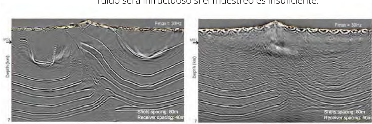
Figura 29A. Las irregularidades superficiales generan patrones complejos de dispersión de energía que afectan dramáticamente la imagen profunda y que deben ser adecuadamente muestreados para que su remoción sea factible. Gerea (2011)
