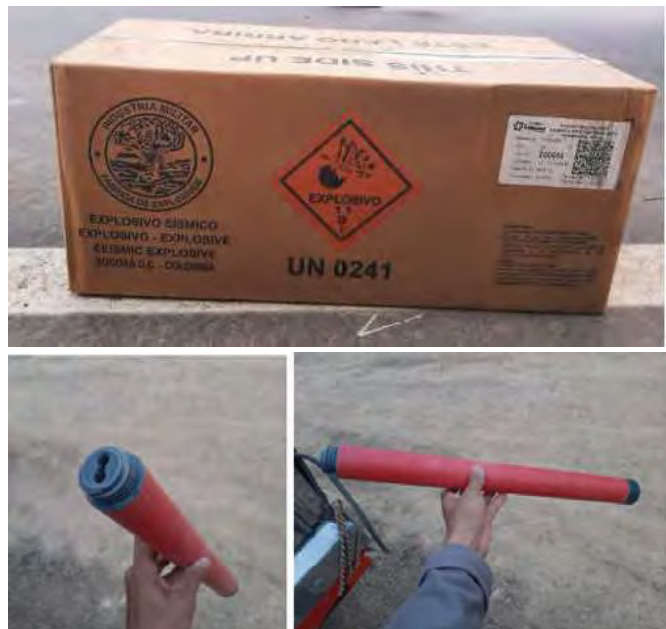
Figura 85. Arriba, caja de 16 unidades de 900 g de 53 cm x 23 cm x 23 cm. Abajo: unidad individual de 900 g de sismigel plus empacada en pvc roscado de 26 cm de largo y 4 cm de diámetro.
