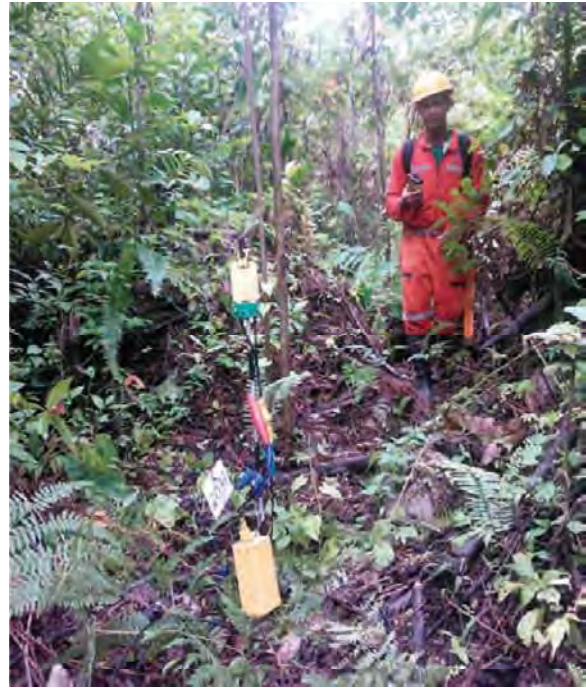
Figura 53. Ejemplo de una estación autónoma de grabación del sistema Autoseis, como las utilizadas en Colombia en 2014 según reporta Alfonso (2015).
