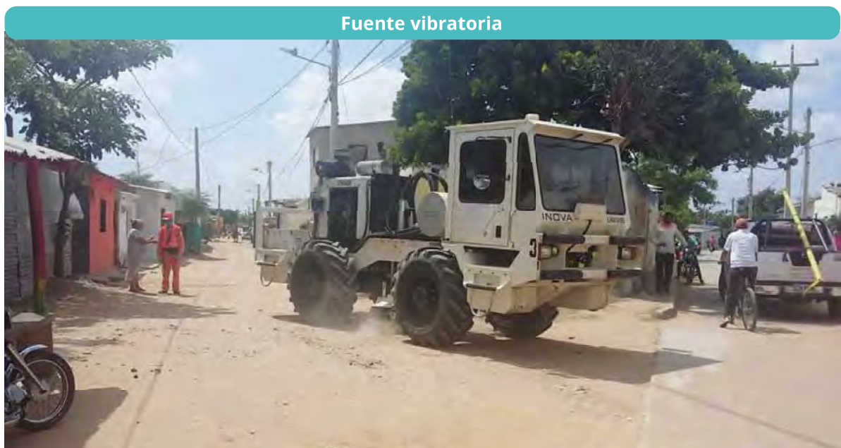
Figura 39. Ejemplo de la utilización de un univib en zona urbana. Previamente se ha adelantado el proceso informativo con las comunidades lo cual permite operar sin apenas alterar la cotidianidad de los habitantes.
