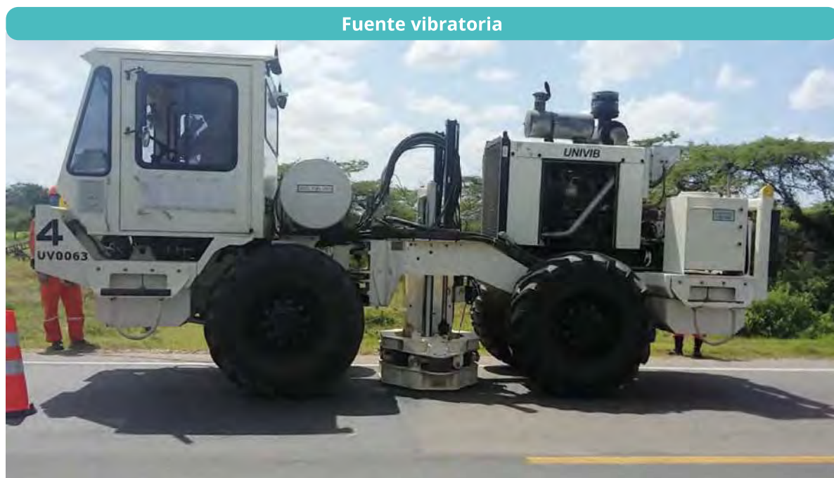
Figura 38. El univib pl-236 es el vibrador más comúnmente utilizado en Colombia. En la imagen se aprecia operando sobre vía pavimentada con su plancha de 1,02 m 2 sin que se produzca ninguna afectación sobre la infraestructura. Foto archivo personal del autor.
